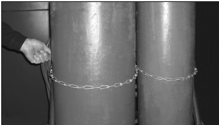
Figure 8 : Blocage des bouteilles sur un chariot
