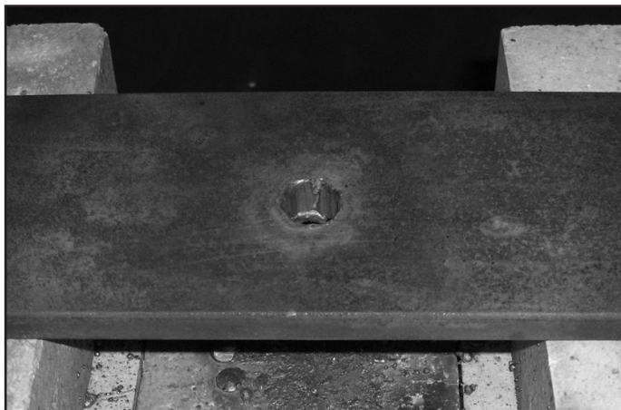
Figura 22: Corte mediante perforación
