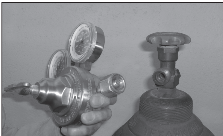
Figure 9 : Inspection de la bouteille et du robinet
