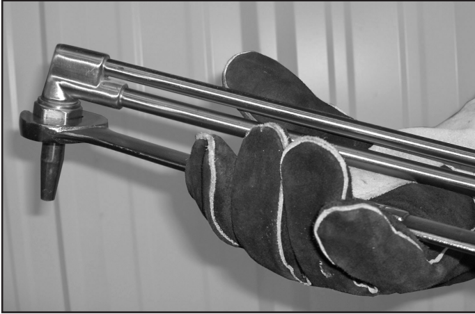
Figura 17: Cómo ajustar la tuerca de la punta
